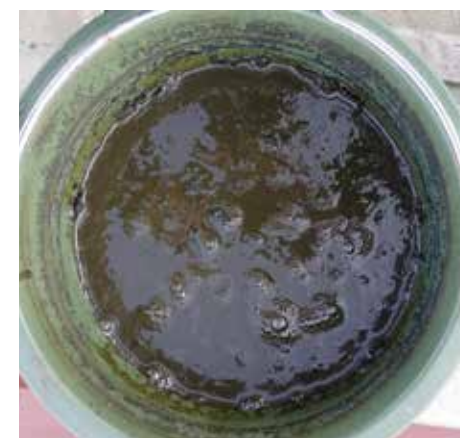
Après un bref brassage : L'échantillon présentait une odeur très désagréable et les structures non dégradées étaient encore très visibles. Au niveau de la couleur, ce lisier de digestat n'était pas homogène, tâché et plutôt clair.
